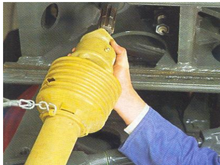
Σύνδεση στο πολύσφηνο του PTO
