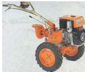
Μονοαξονικός ελκυστήρας με αντλία νερού
