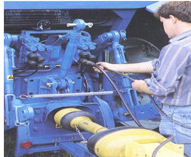
Σύνδεση των υδραυλικών του παρελκόμενου
